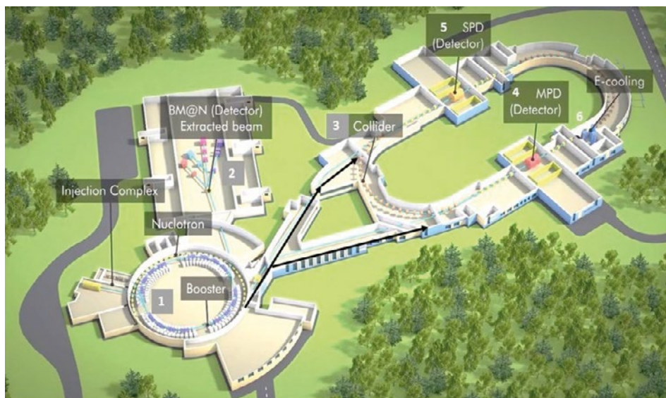
Рис. 1.1. Схема комплекса NICA: два линейных ускорителя (Injection Complex), Бустер (Booster) и Нуклотрон (Nuclotron), расположенные в существующем здании Синхрофазотрона (1), каналы транспортировки пучка к детекторам для экспериментов на фиксированной мишени (BM@N) в существующем экспериментальном корпусе (2), новое здание для размещения колец коллайдера (3) с павильонами для двух детекторов — MPD (4) и SPD (5) и здание системы электронного охлаждения (6)
