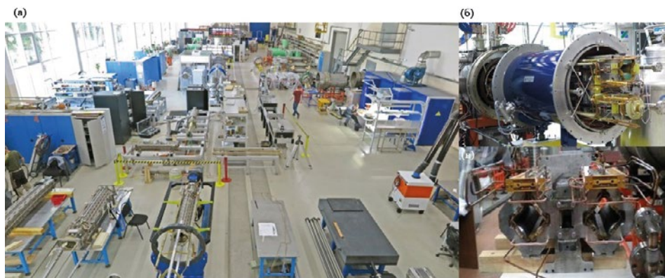
Рис. 1.3. Производство сверхпроводящих магнитов: участок сборки и испытания магнитов (а); двухапертурные магниты Коллайдера NICA: дипольный (б) и квадрупольный (в)
